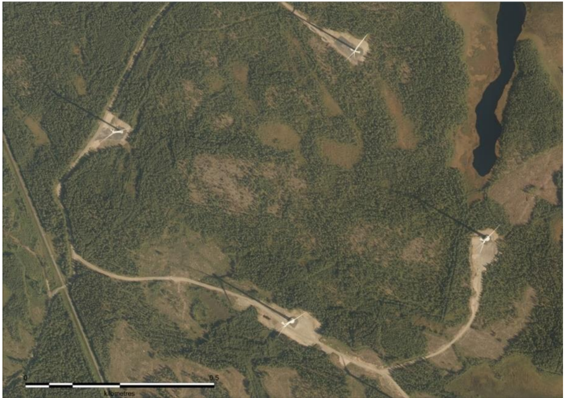
Kuva 11. Ilmakuvassa näkyy toiminnassa olevia tuulivoimaloita. Tuulivoimaloita varten on rakennettu huoltotiet ja nostokentät. Tuulivoimaloiden ympäristössä ja välialueilla aikaisempi maankäyttö on säilynyt ennallaan. Kuva ei ole Napalankallioiden, Hietaharjunkankaan ja Palopättäränmäen alueelta. (Maanmittauslaitos, ortoilmakuva)
